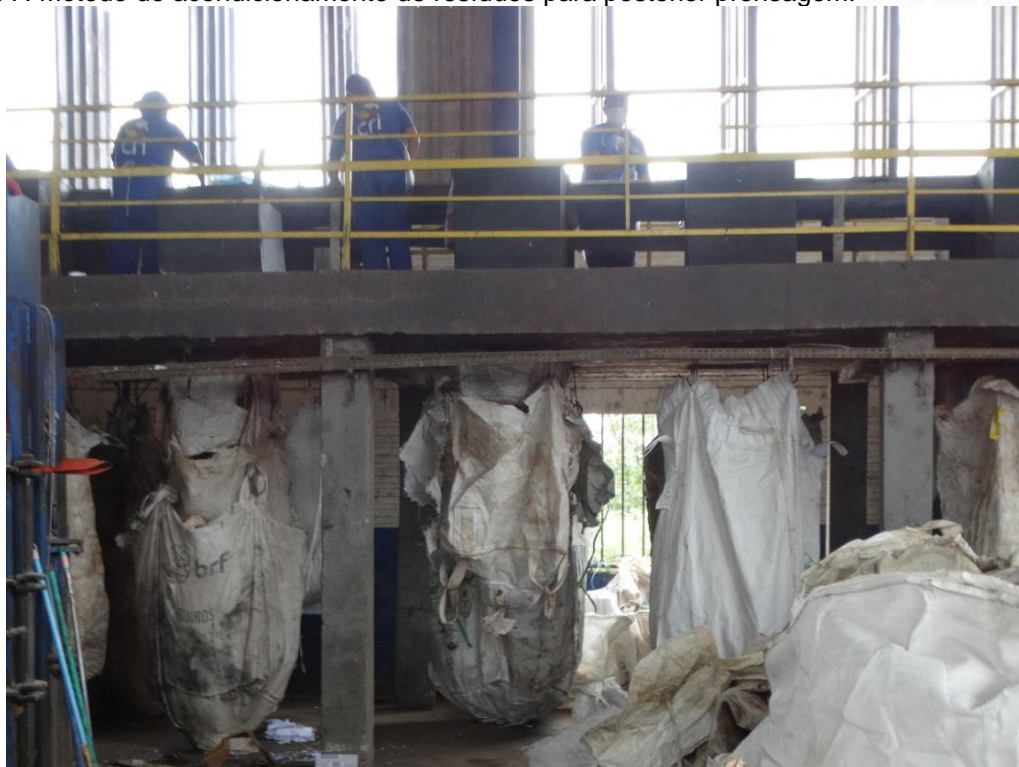
Figura 77: Método de acondicionamento de resíduos para posterior prensagem.
